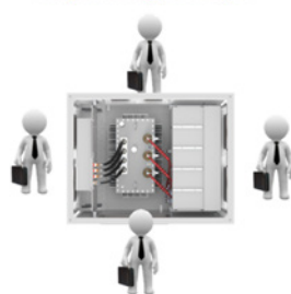
Rys. 8. Badanie stacji według klasyfikacji IAC-B.
