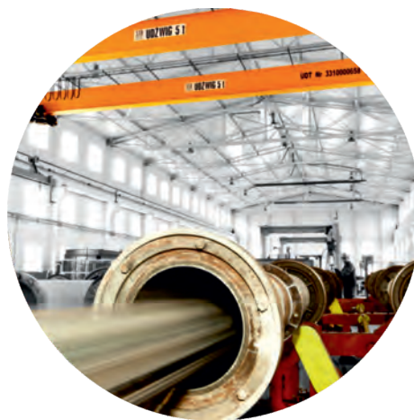
Zautomatyzowana, precyzyjna linia produkcji żerdzi betonowych. Automated, precise production line for concrete poles.
