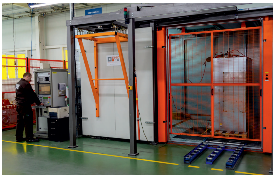
Stanowisko do prób napięciowych z klatką Faradaya.
