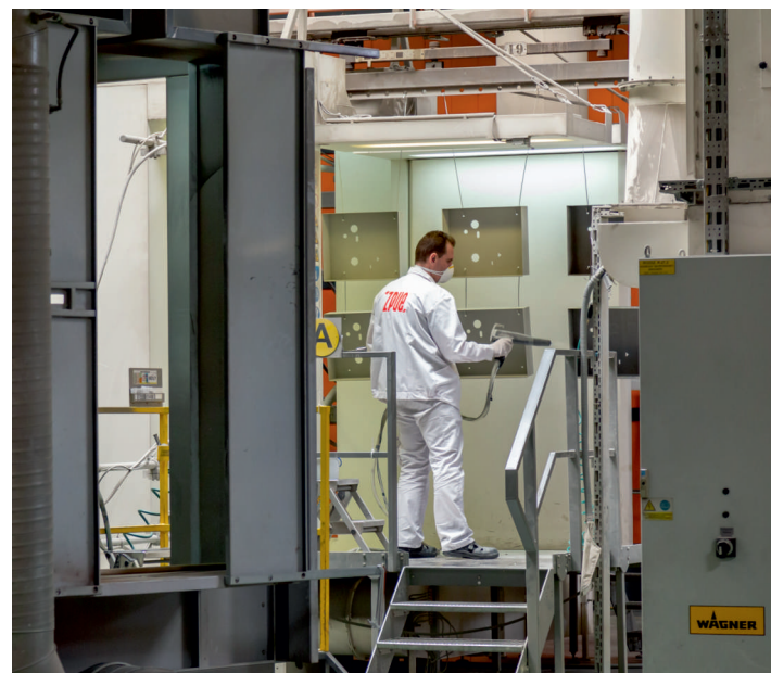
Automatyczna i kompleksowa linia lakiernicza – od przygotowania powierzchni przez nakładanie powłoki lakierniczej po suszenie i utwardzanie.
