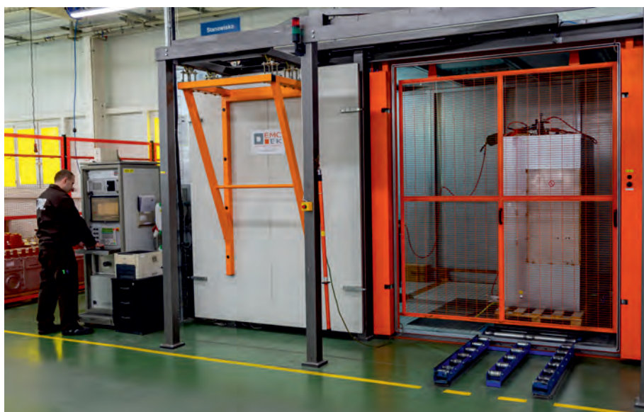
Stanowisko do prób napięciowych z klatką Faradaya.
