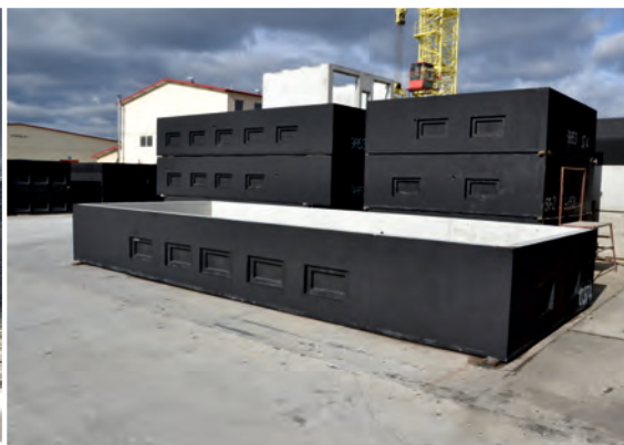
Fundamenty stacji MRw-b (przykłady)
