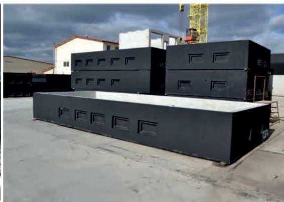
Fundamenty stacji MRw-b (przykłady)
