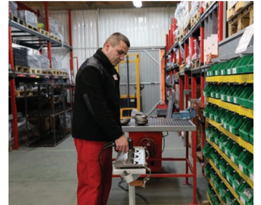
Stanowisko autorstwa Bartosza Podlaskiego usprawniło proces produkcyjny wstrzeliwania trzpieni nierdzewnych w blachę elektrody do podstaw transformatorowych SF i rozłączników.
